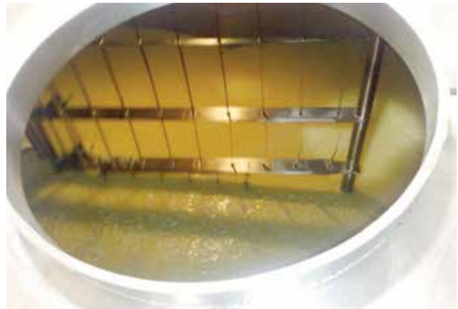
Figura 4. Tina doble OO, en la que la tapa se abre solo para adicionar calcio y cuajo.
