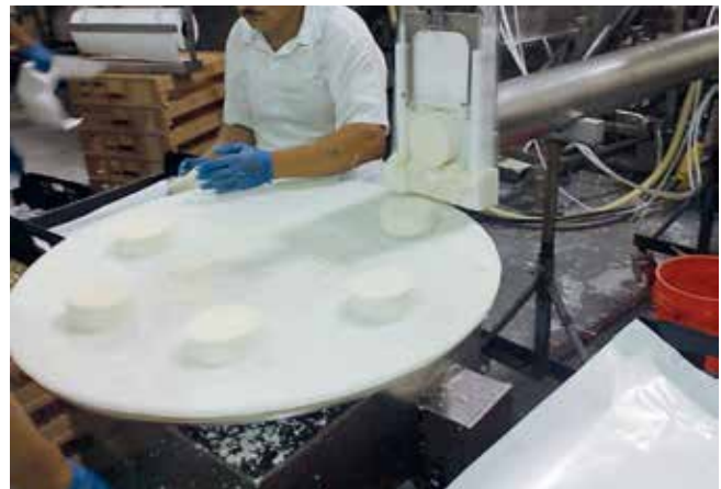
Figura 8. Sistemas automatizados de moldeo, utilizados por el autor en Wisconsin, Estados Unidos.
