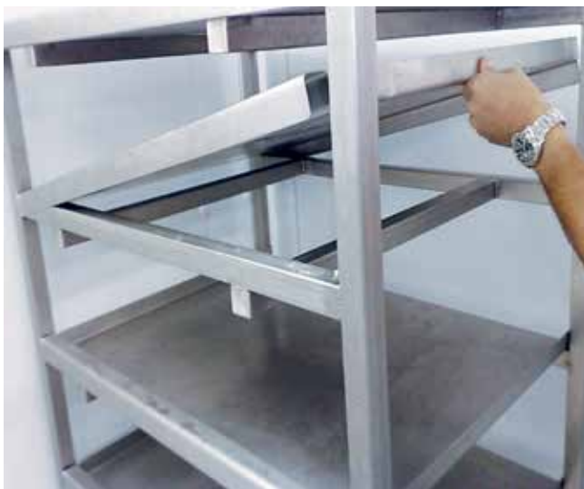
Figura 2. Estante para queso 100% lavable y desarmable, sin puntos muertos de contaminación y soldaduras grado alimenticio.
