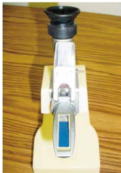
Figura 1. Refractómetro utilizado para medir la concentración de inmunoglobulinas en el suero sanguíneo de los animales. Fuente: Propia
