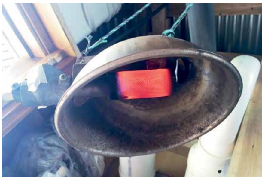
Figura 6. Criadora SpaceRay modelo SHP3, modificada a biogás, de forma artesanal por la empresa VIOGAZ S.A.
