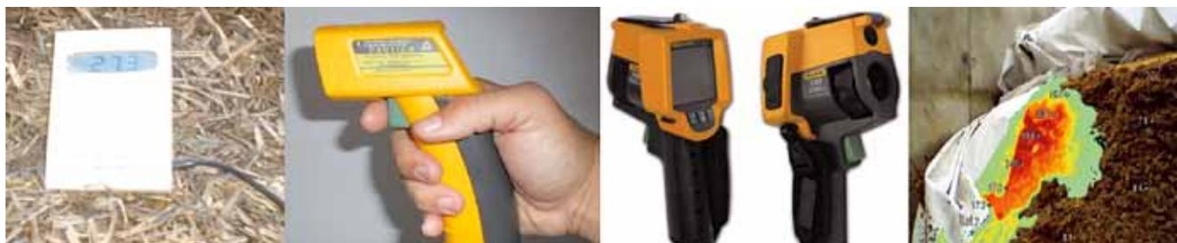
Figuras 3 – 6. (3) Termómetro; (4) Termómetro infrarrojo; (5) Cámara térmica; y (6) Imagen térmica del ensilado.
